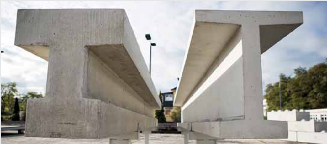
Doppel-T-Träger: Der Vergleich zwischen Stahl- (links) und Carbon- beton. Foto: Thilo Schoch
