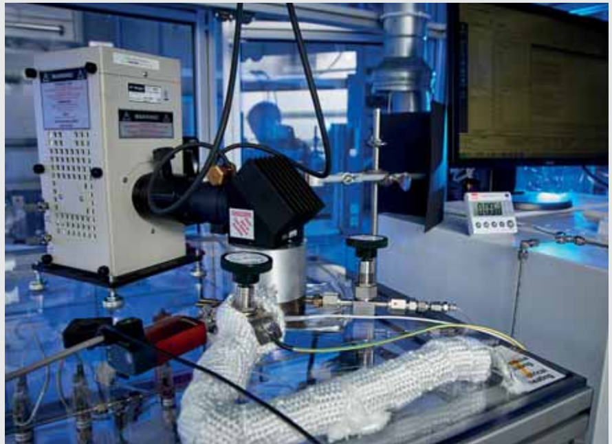
Photokatalysator und Licht beschleunigen die Reaktion von Methan und \text{CO}_2 zu Synthesegas. Hier zu sehen sind die Lichtquelle und der Photoreaktor. Foto: LIKAT, nordlicht
